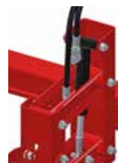
Hydraulisches Ausheben und Druck mittels LS- oder Ölumlaufsteuerung
